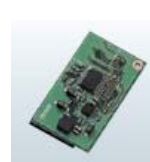
UT-124R moduł przewrócenia (Man down); automatycznie wysyła sygnał alarmowy, gdy radiotelefon przez określony czas znajduje się w pozycji poziomej
